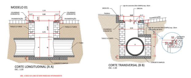
As paredes serão de alvenaria de tijolo maciço, com espessura 22 centímetros, assentadas e rebocadas com argamassa de cimento, cal hidratada e areia média traço 1:2:8 respectivamente, a caixa coletora será somente rebocada internamente.
