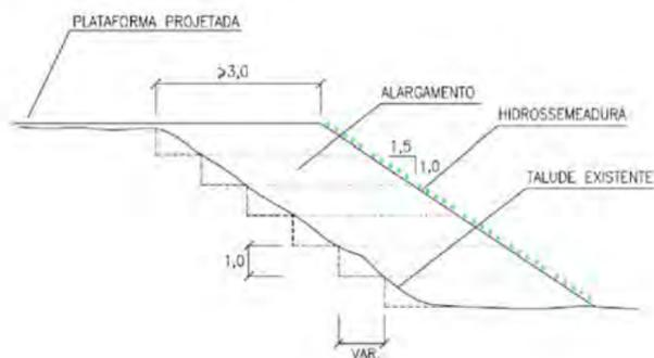
ALARGAMENTO DE ATERRO EXISTENTE COM LARGURA < 3,00m
