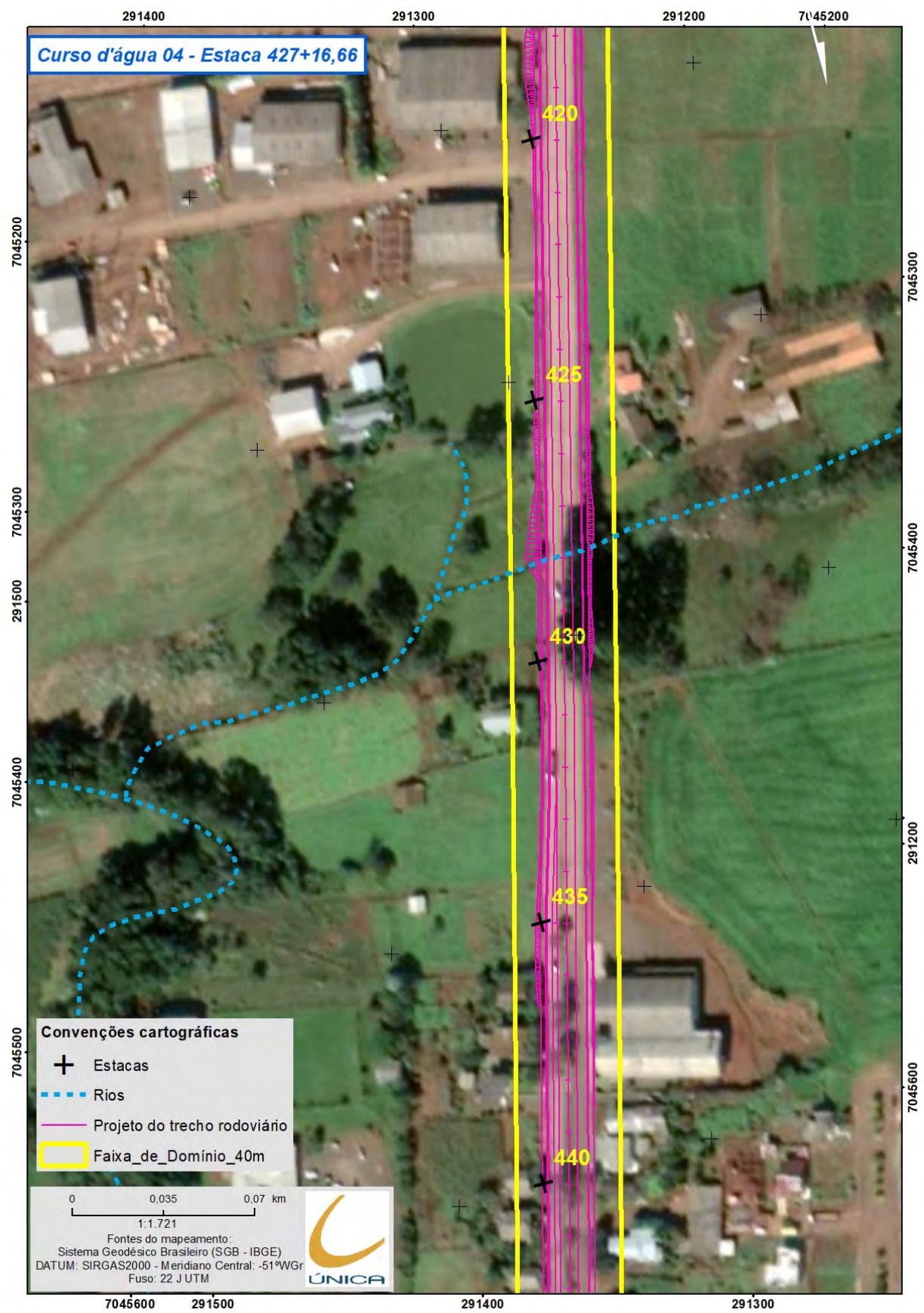
Figura – Curso d'água 04 transpassado pelo trecho rodoviário na estaca 427+16,66.
