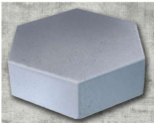
A pavimentação será executada com lajota sextavada, resistência mínima de 35 Mpa (NBR 9781 - Peças de concreto para pavimentação — Especificação e métodos de ensaio), assentadas sobre berço de 5,0 cm de areia. Sendo a areia limpa e isenta de matéria orgânica.
